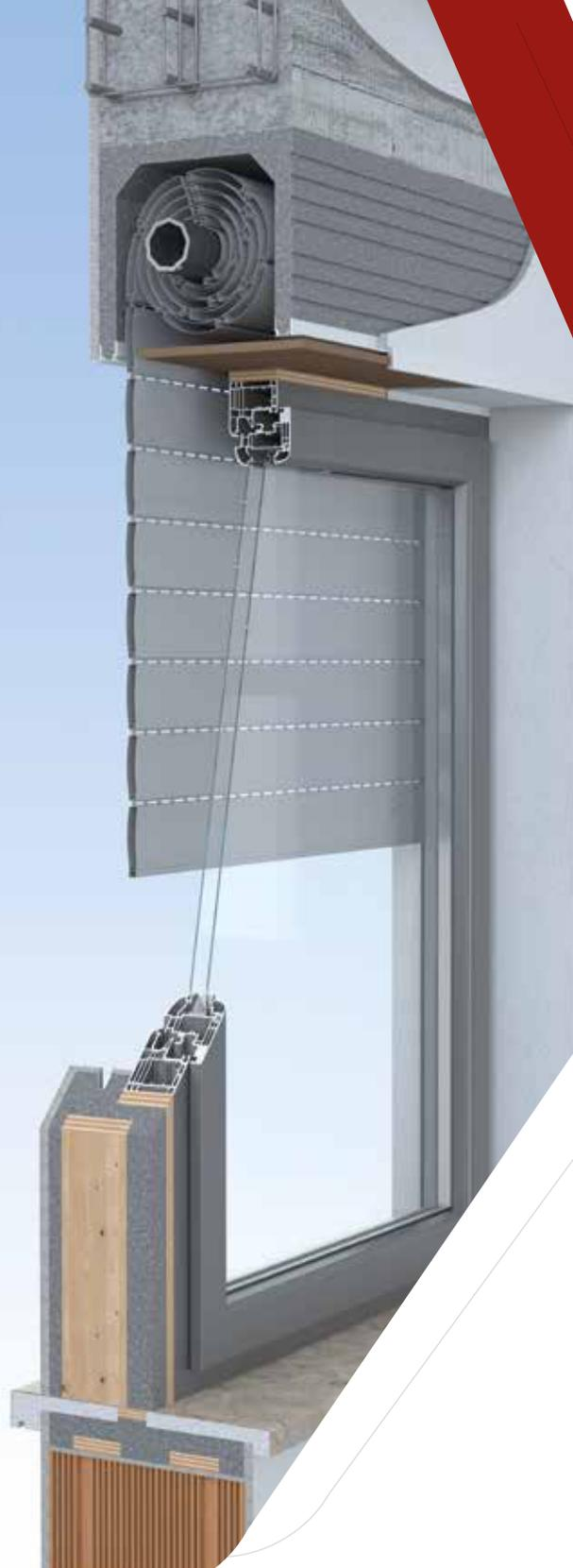
Tipologia di cassetto tradizionale, da utilizzare quando non si desidera l'ispezione a vista, ma non è disponibile lo spessore per il tampono. Consente la rimozione del ciellino dall'interno con estrema semplicità, mentre l'infisso è posizionato in mazzetta.
