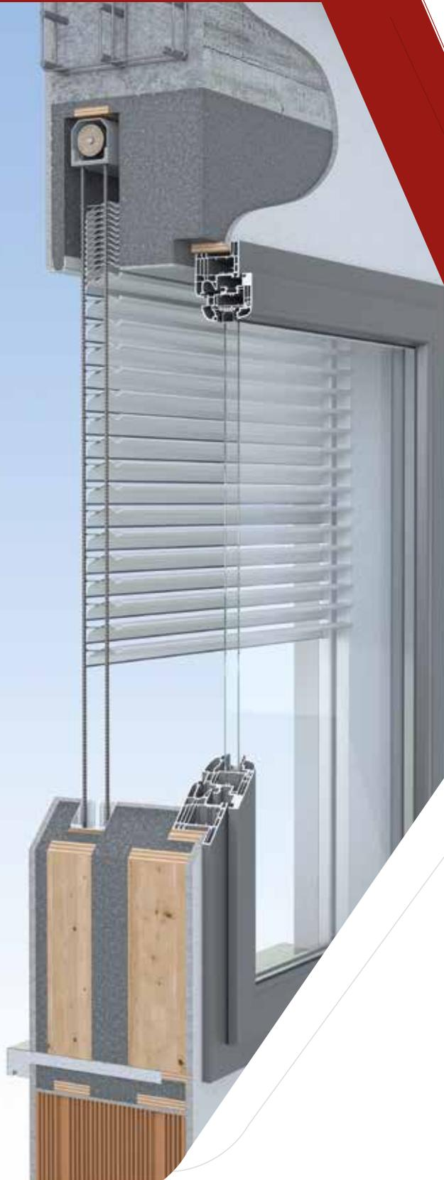
Si tratta di un cassetto termico a copertura della struttura portante dell'**oscurante frangisole**.
