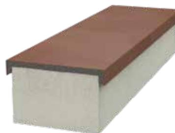
Elemento utilizzato per rivestire la parte superiore di un muro ed in grado di raggiungere diversi scopi: **protezione, estetica e drenaggio**, riducendo così la possibilità di infiltrazioni o danni causati dall'umidità.
